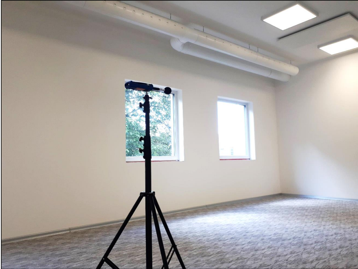
Obr. 2 Pohled na měřicí aparaturu v pozici P4 se zdrojem hluku – pod stropem umístěný systém přívodu vzduchu
