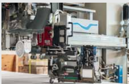
Obr. 2: Sponkovací most pro strojní upevnění
