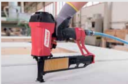
Obr. 1: Sponkovačka pro ruční upevnění
