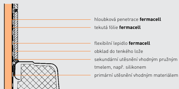
Stěnové napojení sprchy nebo vany na montovanou stěnu s jednovrstvým opláštěním Powerpanel H 2 O
