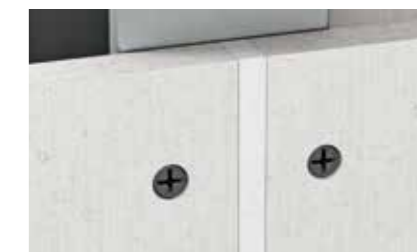
Tmelená spára fermacell™ – šířka spáry: 1/2 x tloušťka desky + max. 3 mm
