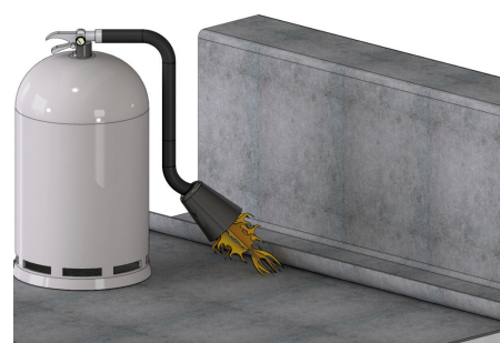
3. Překrýt první vrstvou svislého asfaltového podkladního pásu
