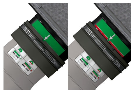
6. Odtokovou trubku s tabletem spojit nasunutím tak, aby nebyl vidět červený proužek.
