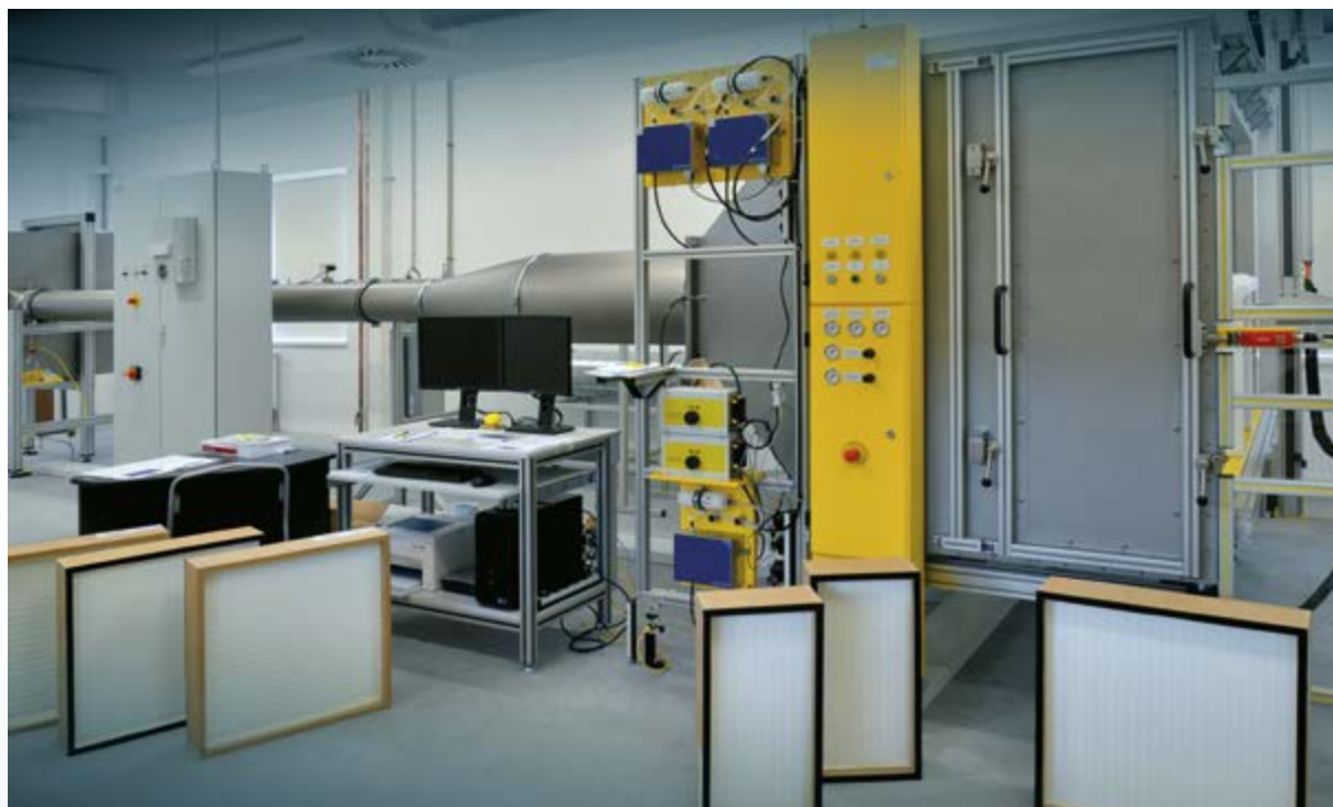
Automatické zařízení pro testování - SCAN TEST pro HEPA a ULPA filtry
