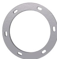
Obr. 52 V případě požadavku požární odolnosti EI 120 ovšem potrubí vyžaduje vnější zesílení pomocí kruhových obručí 40 × 5 mm umístěných mezi závěsy po vzdálenostech 1200 mm (šířka rohože je 600 mm)
