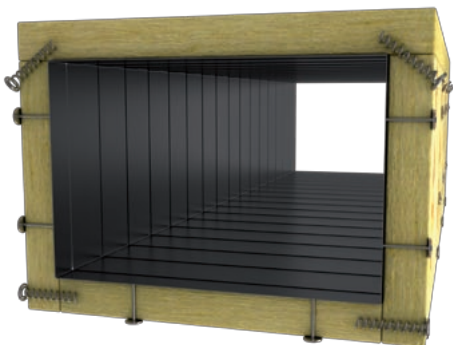
Obr. 63 Horní deska překrývá boční desky, které překrývají spodní desku
