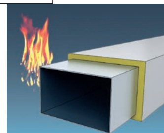
Obr. 5 Příkladem požáru působícího na vzduchotechnické potrubí z vnější strany (potrubí A), může být situace, kdy vzduchovod od větracího zařízení, které větrá prostor bez požárního rizika (chodba, hala, jinak i např. WC, sprchy), prochází bez vyústek jiným požárním úsekem, kde požární riziko je (např. kanceláře)
