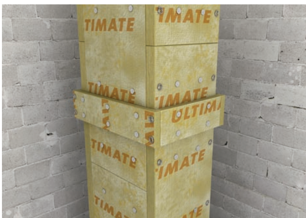
Obr. 71 Rozmístění trnů a vrutů Fire Screw u přídavné druhé vrstvy izolace
