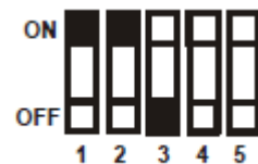
2-trubk. fan-coil a radiátor/podlaha
