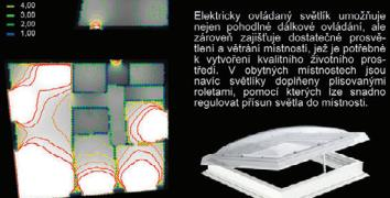
Elektricky ovládaný svítílek umožňuje nejen pochopitelně dálkové ovládání, ale zároveň zajistuje dostatečné prostření v místnostech, což je významné k vytvoření kvalitního životního prostředí. V obytných místnostech jsou namontovány sklopné skříňky s roletami, pomocí kterých lze snadno regulovat průtok světla do místnosti.
