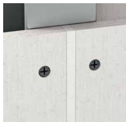
Tmelená spára fermacell – šířka spáry: \frac{1}{2} x tloušťka desky + max. 3 mm
