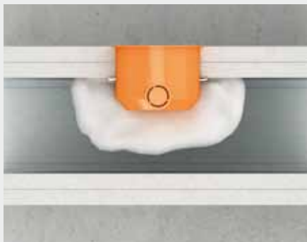
Montážní stěna bez izolace pro protipožární ochranu – zásuvky, krabice vypínačů a rozdělovačů atd. musí být uvnitř dutiny stěny kompletně zabudovány za pomoci spárovacího tmelu fermacell o minimální tloušťce 20 mm.
