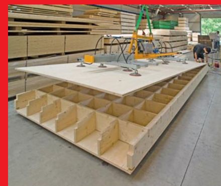
VÝROBA ŽEBROVÝCH PANELŮ
