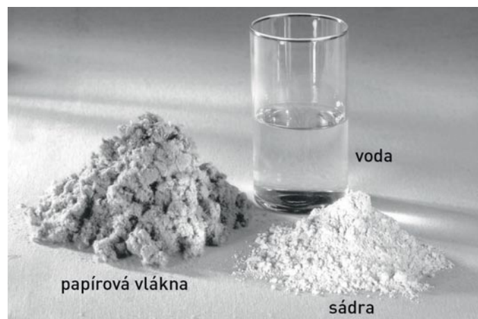
Základní suroviny pro výrobu sádrovláknitých desek
