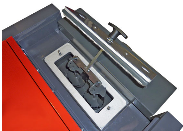
Trubkový výměník s brzdiči
