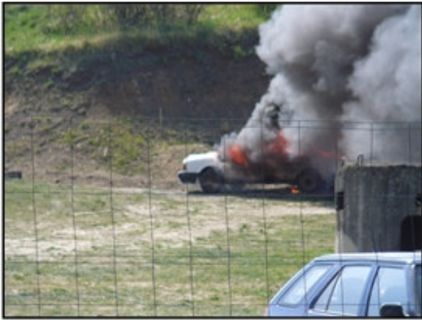
Obr. 11 - Požár osobního vozidla převážejícího netěsnou PB láhev 2 kg.
