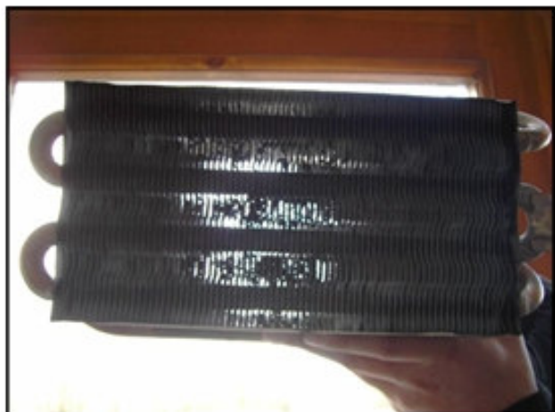
Obr. 1 - Znečištěný výměník plynového kotle, neprováděný pravidelný servis - smrtelná otrava CO.
