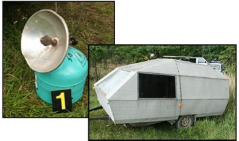
Obr. 9 a 10 - Teplomet Ardent typ 2171 používaný v karavanu způsobil po krátké době provozu smrtelnou otravu.
