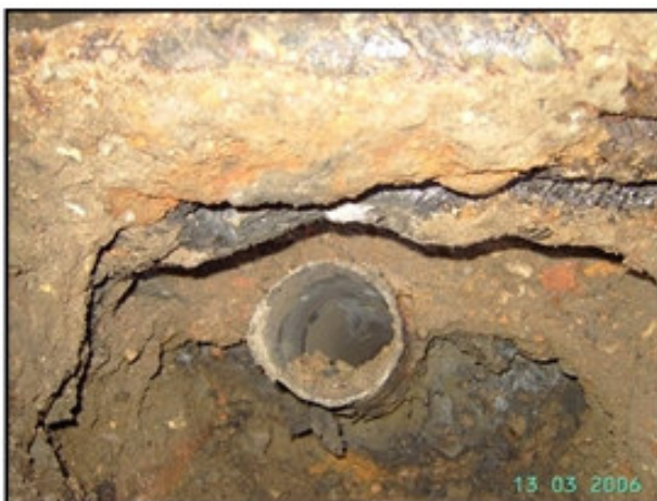
Obr. 13 a 14 - Čelní pohled na utavené potrubí plynovodní přípojky. V horní části nad potrubím je vidět částečně utavený kabel, který nehodu způsobil a celkový pohled na místo tragédie.
